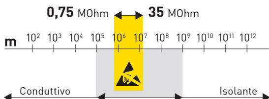
Prodotti certificati secondo la EN 61340-4-3 ed EN 61340-5-1 per la protezione dei dispositivi elettronici dal pericolo di cariche elettrostatiche.
